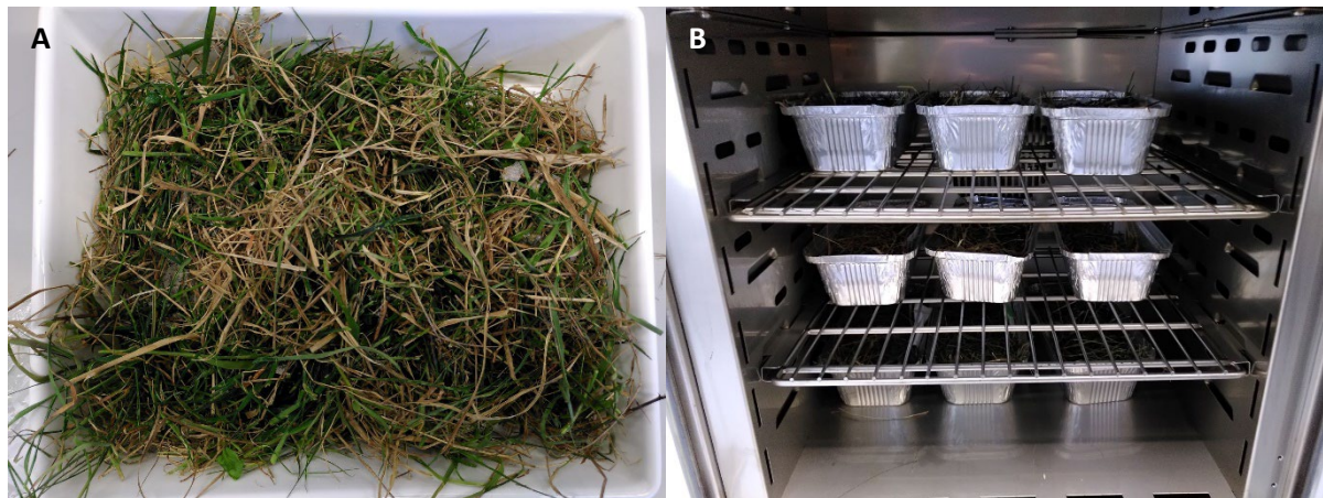
Abb. 8: A: Durchmischen und zerkleinern der Probe. B: Trocknen der Proben in Aluschalen bei 69°C im Trockenschrank
