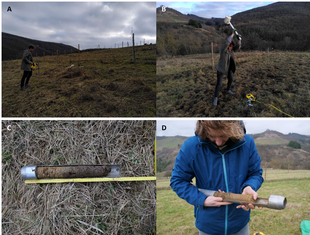
Abb. 13: A: Einmessen des Probestandortes mit einem Maßband. B: einschlagen des Probenehmers. C: Messung der Länge der Bodensäule. D Einführen der Bodensäule in die Transporthüllen
